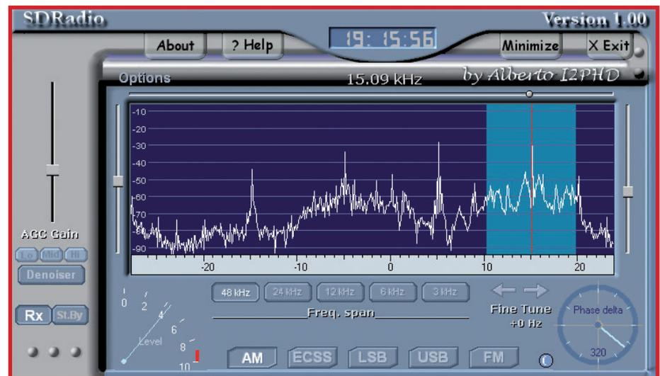
Bild 5. Vier AM-Stationen im empfangenen Spektrum, angezeigt durch das Programm SDRadio.
